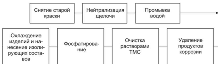
Рис. 1 – Возможный перечень и последовательность операций при подготовке металлических поверхностей к окрашиванию
