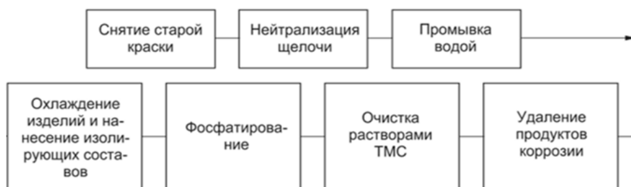
Рис. 1 – Возможный перечень и последовательность операций при подготовке металлических поверхностей к окрашиванию
