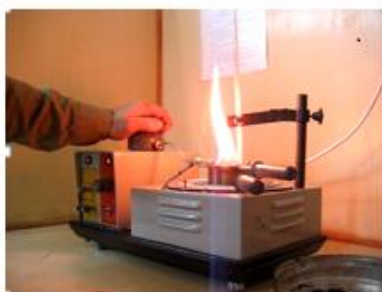
Рис. 1 – Лабораторная работа «Определение температуры вспышки горючих веществ»
