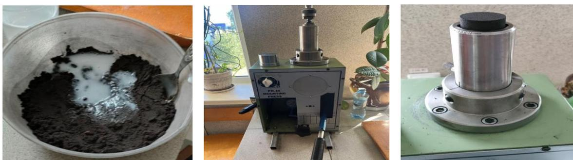
А – смешивание шихты      Б – гидравлический пресс      В – готовый брикет
