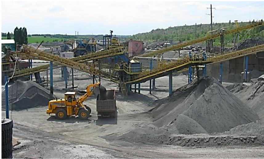
Рис. 1 – Передвижная дробильно-сортировочная установка
