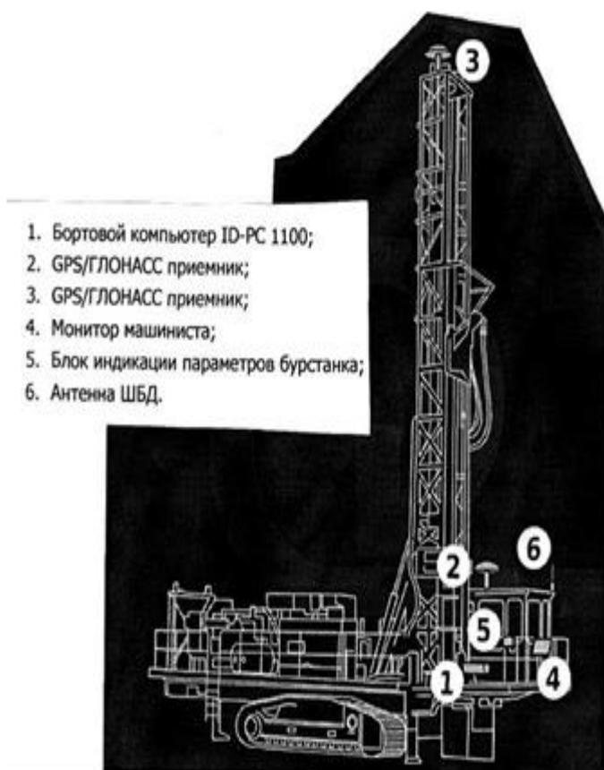
Рис. 4 – расположение приемников системы «АВС-1» на СБШ-250МНА-32
