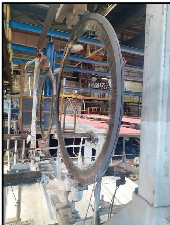
Рис. 4 – Кольцо дефектоскопа.
