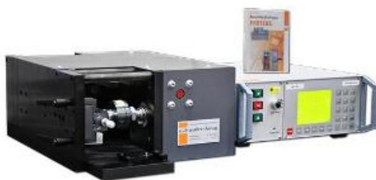
Рис. 2 – Установка для испытания на адгезионный износ
