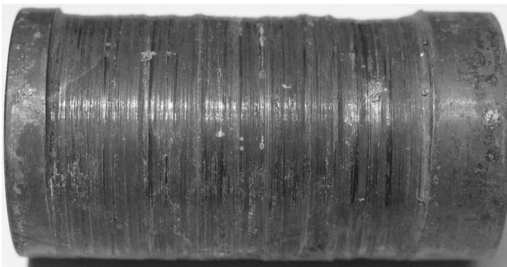
Рис. 3 – Фото абразивного износа оси поворота ковша экскаватора
