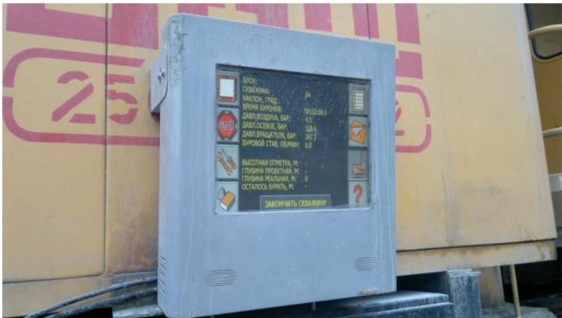
Рис. 6 – Выносной экран для управления буровым станком
