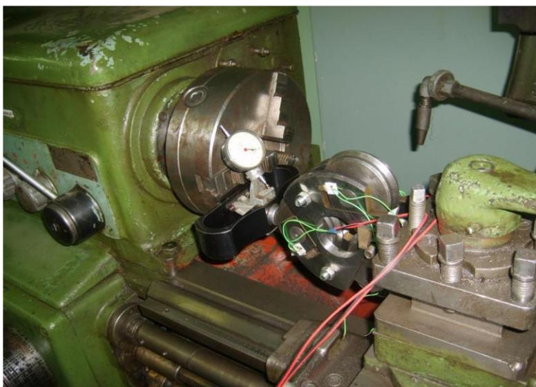
Рис. 3 – Тарировка головки
