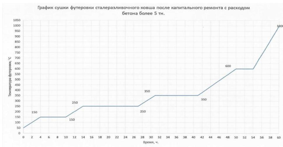
Рис. 1 – График сушки футеровки сталеразливочного ковша после капитального ремонта с расходом бетона более 5 тонн
