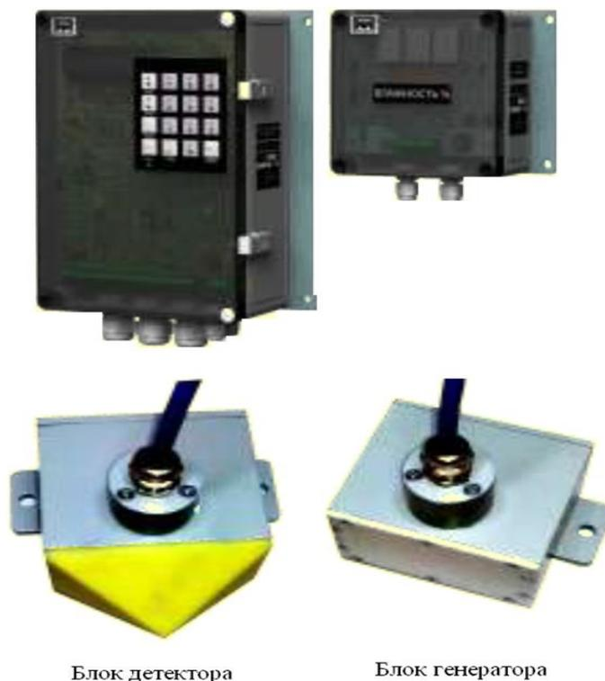
Рис. 5 – Общий вид влагомера МИКРОРАДАР-MR112K13K
