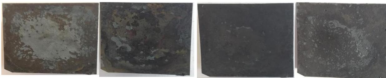
Образец после первого цикла      Образец после второго цикла      Образец после третьего цикла      Образец после четвёртого цикла
