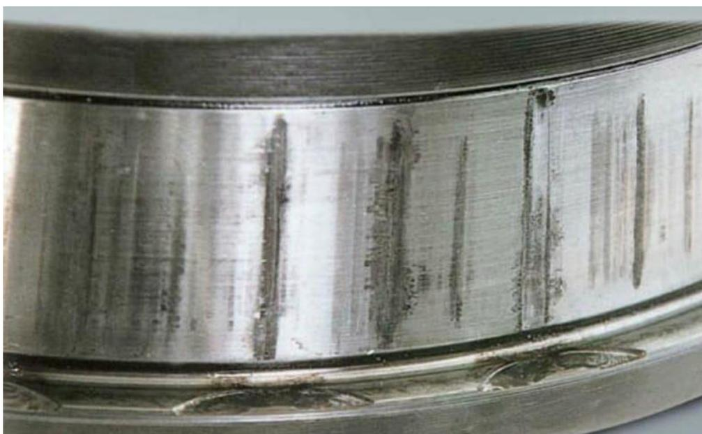
Рис. 2 – Фото адгезионного износа поверхности качения роликов подшипника 30206
