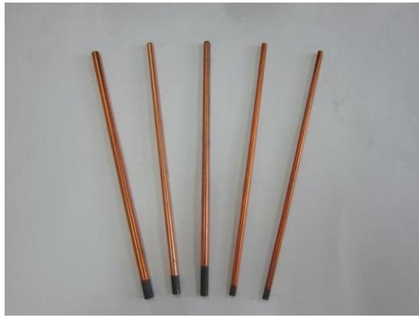
Рис. 2 – Угольные электроды, используемые при КВДУ
