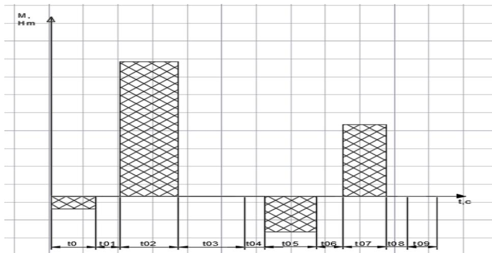
Рис. 3 – Нагрузочная диаграмма ЭП подъема портального крана
