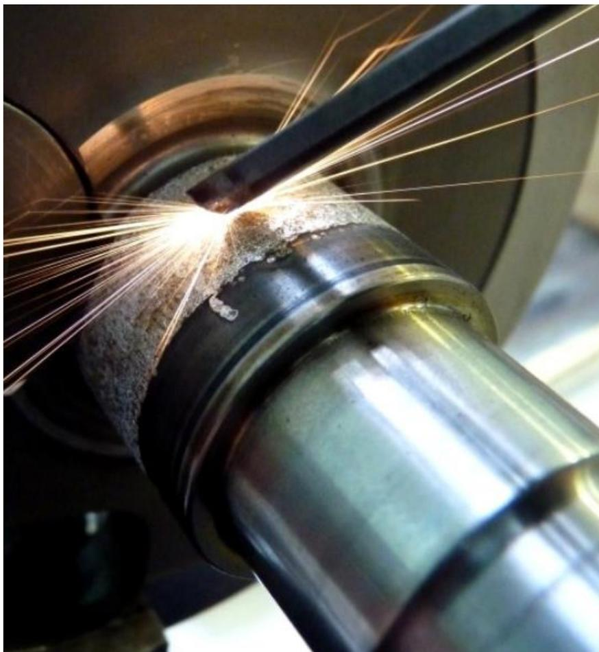
Рис. 4 – Фото технологического процесса нанесения покрытия на детали типа «вал»
