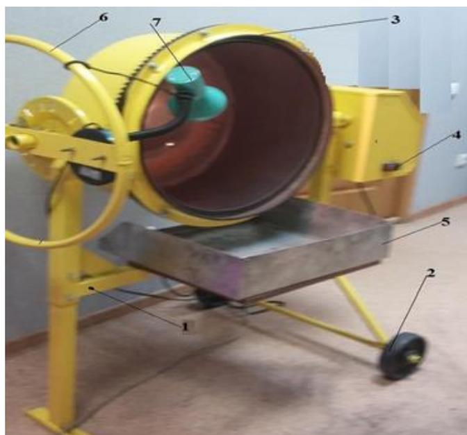
Рис. 1 – Окомкование шихты в лабораторном окомкователе
