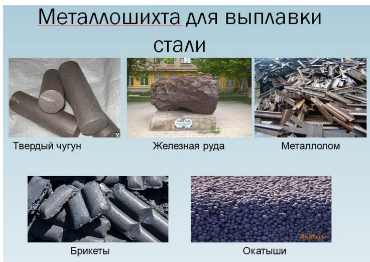
Рис. 1 – Металлошихта для электроплавки в дуговых сталеплавильных печах
