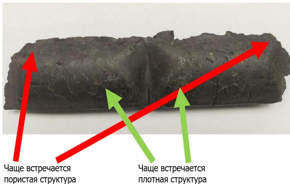
Рис. 3 – Распределение прочности в брикете
