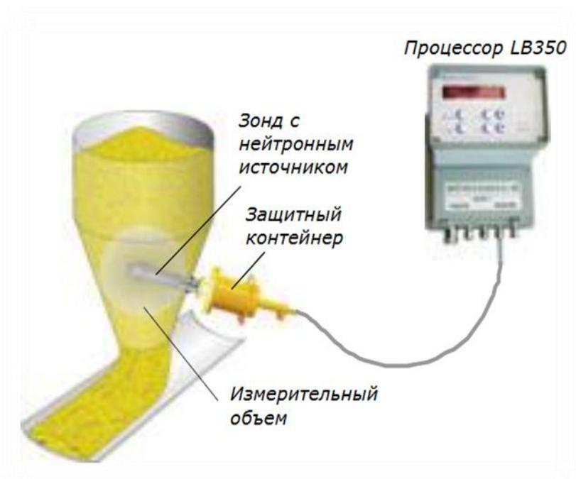
Рис. 3 – Схема контроля влажности LB350 с погружным зондом
