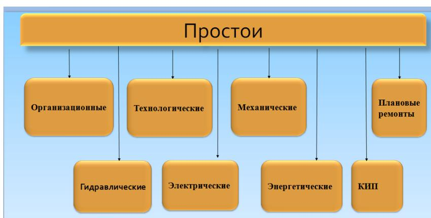
Рис. 1 – Причины межплавочных простоев при выплавке стали в дуговых печах
