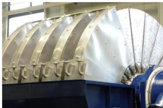
Рис. 1 – Вакуумный фильтр.
