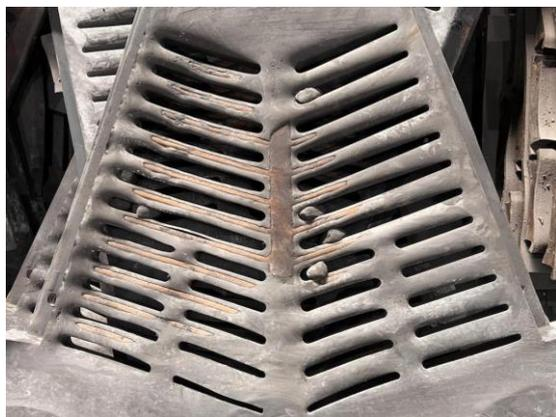
Рис. 5 – Износ футеровки разгрузочной решетки мельницы МРГ
