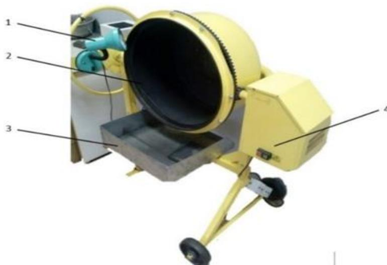
Рис. 1 – Лабораторный окомкователь
