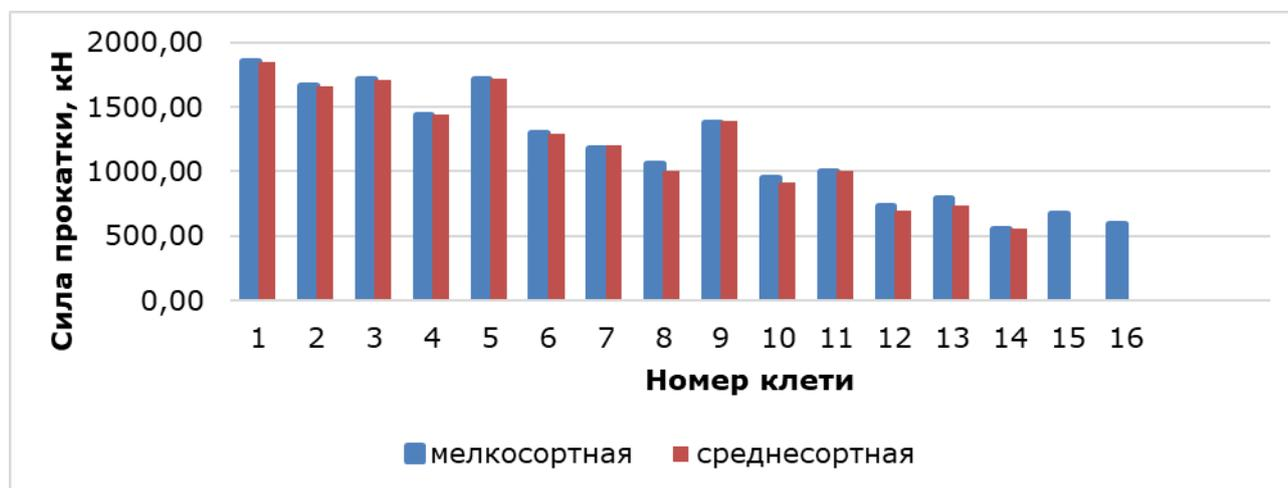
Рис. 2 – Энергосиловые параметры прокатки круга диаметром 40 мм на стане 350 АО «ОЭМК им. А.А. Угарова»
