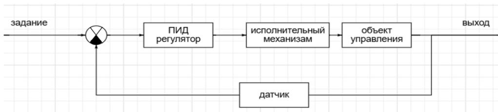
Рис. 1 – Схема управления на основе ПИД регулятора
