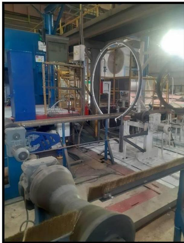
Рис. 6 – Установленное кольцо диаметального обдува трубы перед дефектоскопом.
