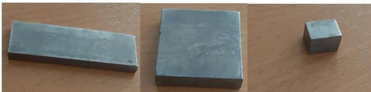
Рис. 1 – Образцы для исследования процесса осадки
