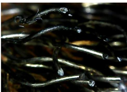
Рис. 2 – Режущая часть микрорезцов дисконной иглофрезы
