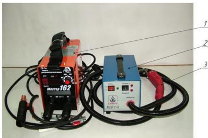
Рис. 1 – Установка ВДГУ-2 для упрочнения: 1 – сварочный инвертор (источник тока); 2 – пульт управления и выбора режимов; 3 – вибратор для закрепления угольного электрода
