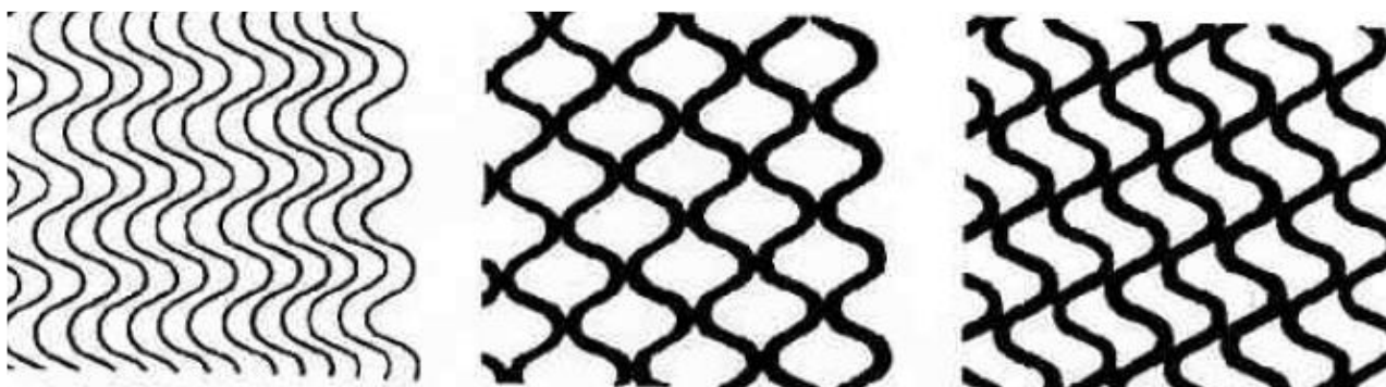
Рис. 5 – Формирование регулярного микрорельефа осевыми колебаниями деформирующего инструмента
