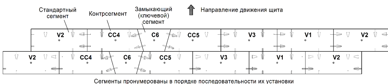
Рис. 1 – Развертка кольца прямоугольной блочной (сегментной) тоннельной обделки
