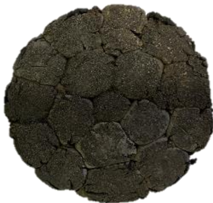
Рис. 2 – Вид брикета, полученного при нагреве окатышей до температуры 800 °С
