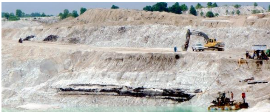
Рис. 3 – Добыча соли экскаватором с применением БВР
