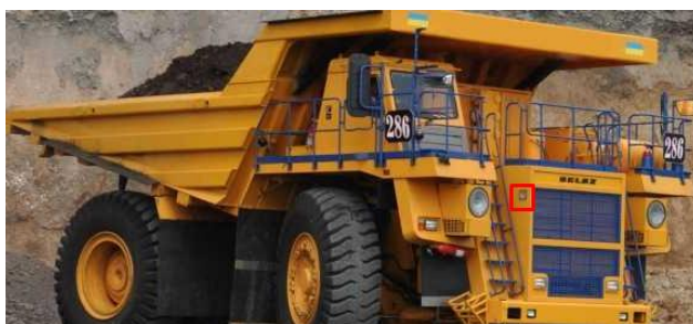
Рис. 9 – Фонарь подсветки лестницы на КС БелАЗ
