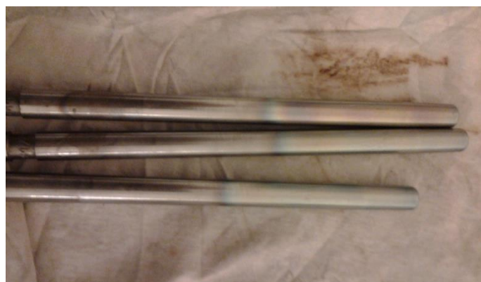
Рис. 3 – Пуансоны вытяжки после нанесения покрытия
