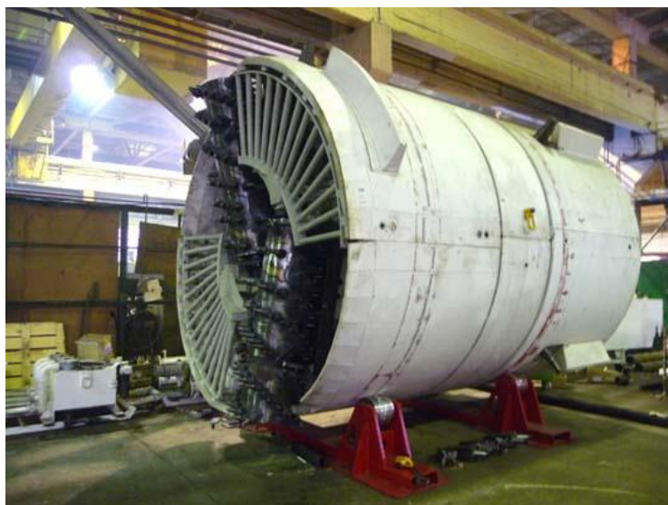
Рис. 1 – Опытный образец геохода модели «401» диаметром 3,2 м
