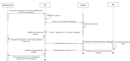
Рисунок 5 – Диаграмма последовательности «Получение информации о состоянии серверов»
