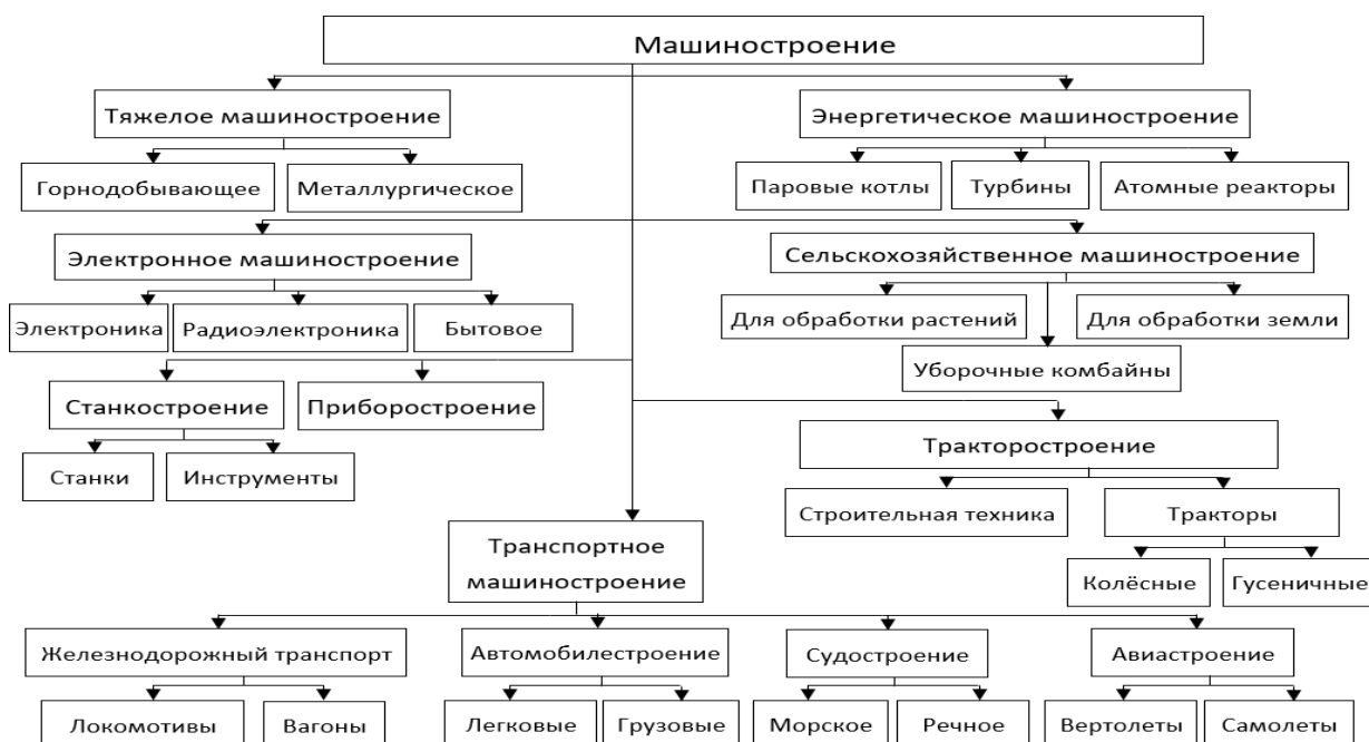
Рис. 1. Структура машиностроительной отрасли
