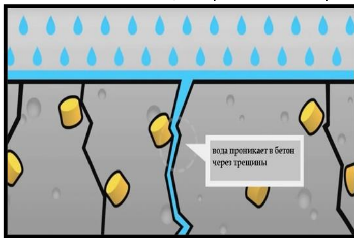
Рисунок1 - Процесс «самовосстанавливания» бетона
