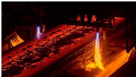
Рисунок 1 – Процесс газовой резки слитков участка МНЛЗ АО «ОЭМК им. А.А. Угарова»
