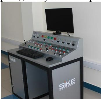
Рис.1 Тренажёрный комплекс "Сталевар электросталеплавильной печи"
