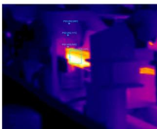
Рисунок 1- Результаты измерения температуры слитка и холостого ролика ППУ МНЛЗ-6
