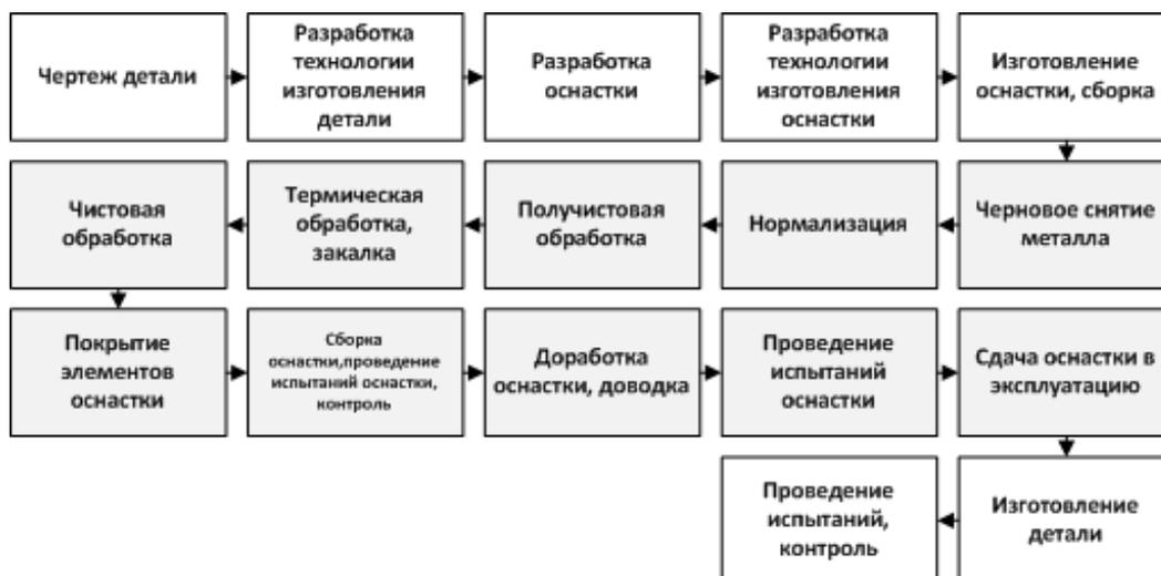
Рисунок 1 - Традиционная технология изготовления литья под давлением
