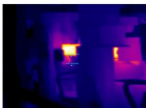
Рисунок 2 - Результаты измерения температуры приводного ролика ППУ МНЛЗ-6
