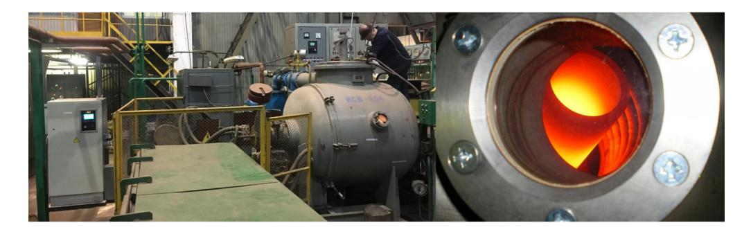
Выплавка сталей и сплавов на уникальной высокотехнологичной вакуумной индукционной печи емкостью 60 кг
