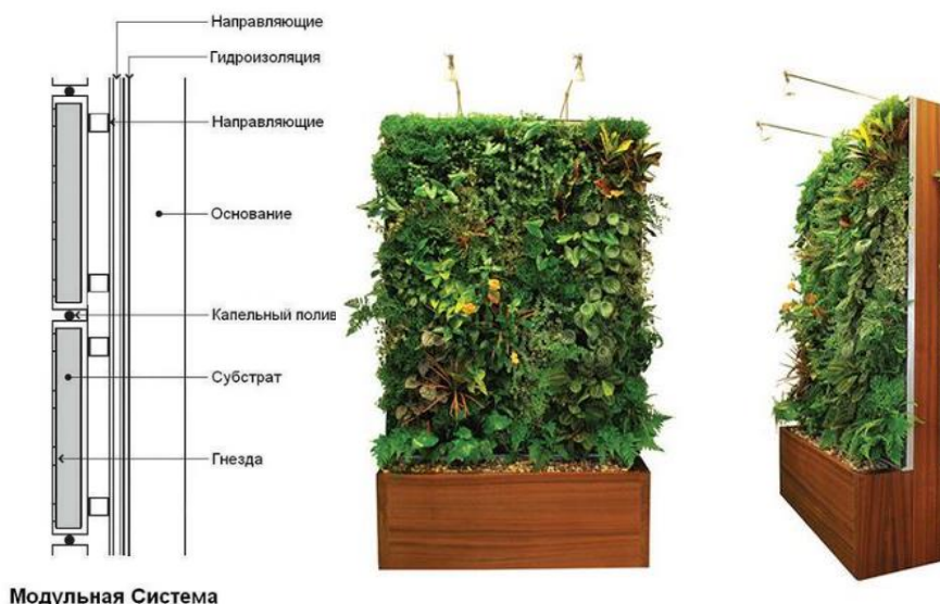
Рис. 3 – Схема и вариант использования модульной системы
