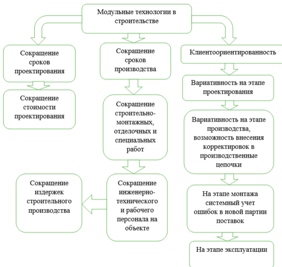
Рис. 1 – Преимущества модульных технологий в строительстве [1]
